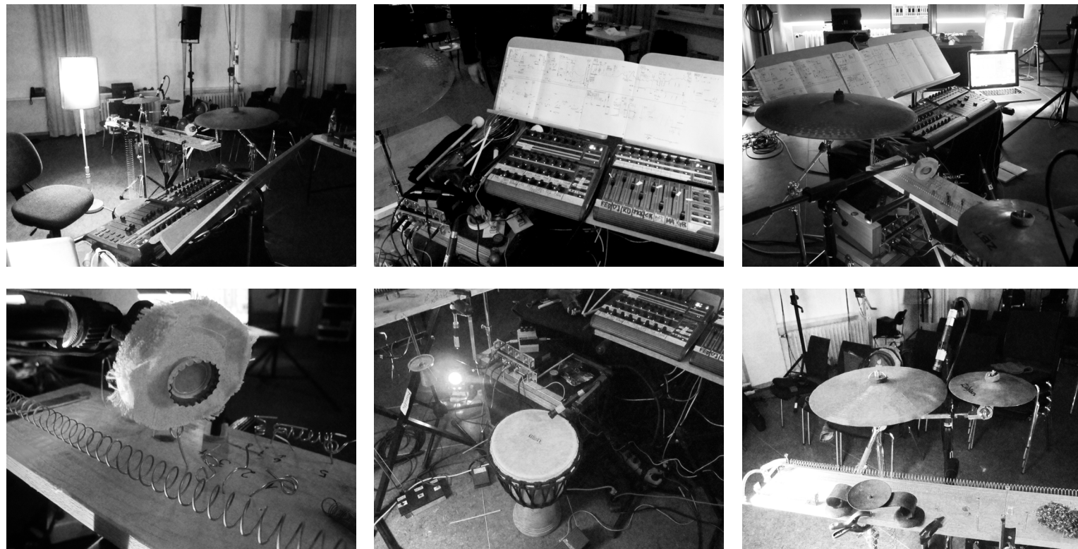
Abbildung 9.1: v.o.l.n.u.r.: Gesamtaufbau von hinten (SEAM-Konzert am 08.02.2013); Ride-Becken und die beiden Behringer-Controller; Front, seitlich; DC-Motor mit Polierscheibe an Kupferdraht; Mikrofonierung der Djembe; Mikrofonierung des Crash-Beckens
